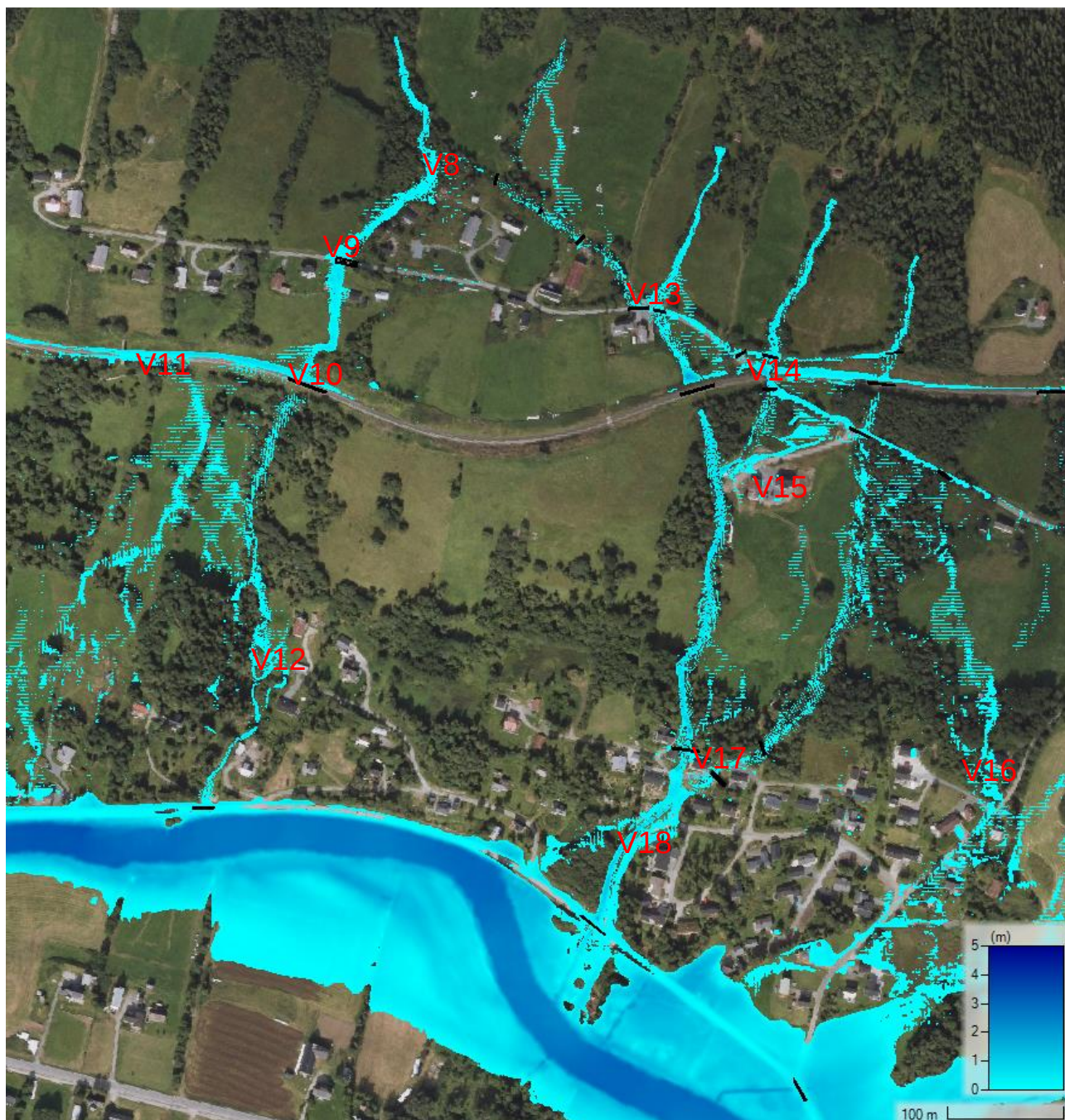
Figur 8. Modellert 200-årsflom med klimapåslag for Almåsbekken. Modellert vannstand (m) er vist i blått.
