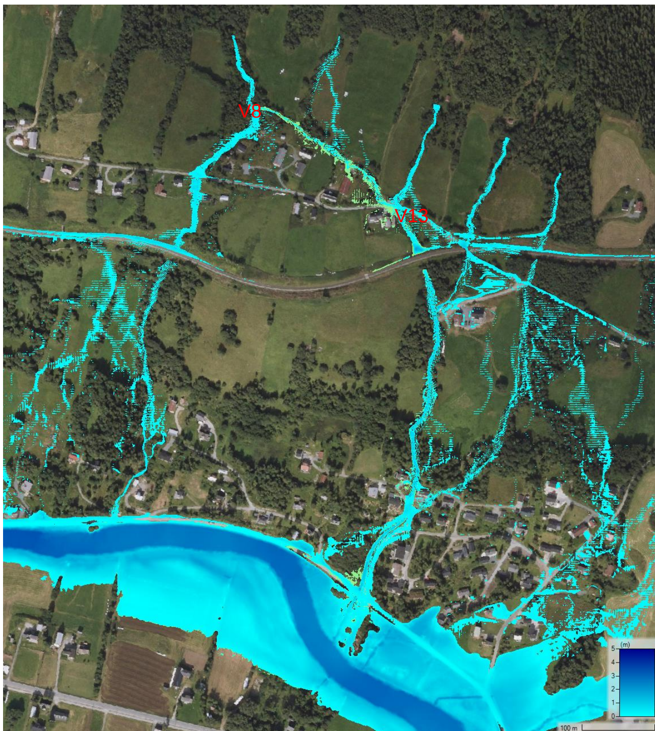
Figur 12. Modellert 200-årsflom med klimapåslag for Almåsbekken. Resultat fra modell med flomvoll som leder alt vannet ved V8 mot øst (grønn), sammenlignet med eksisterende situasjon (blå). Blå sone ligger over grønn sone så endringene er kun synlig der grønn sone er større enn blå.
