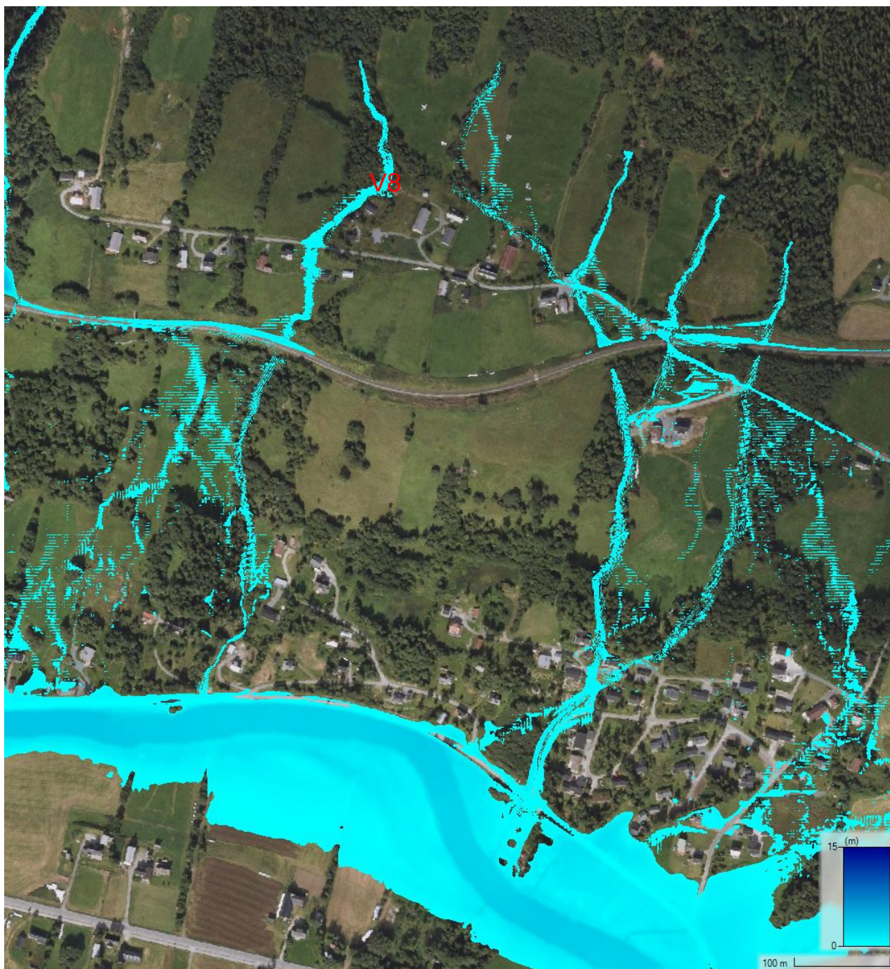
Figur 10. Modellert 200-årsflom med klimapåslag for Almåsbekken med flomvoll som leder alt vannet ved V8 mot sørvest. Modellert vannstand (m) er vist i blått.
