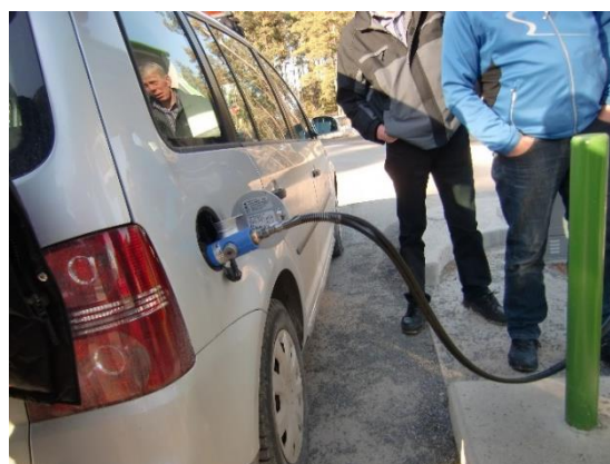
Påfyllingsstasjon for biogass på kommunale biler
